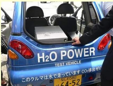
Электроэнергия, получаемая из электролизёра, движет автомобиль
