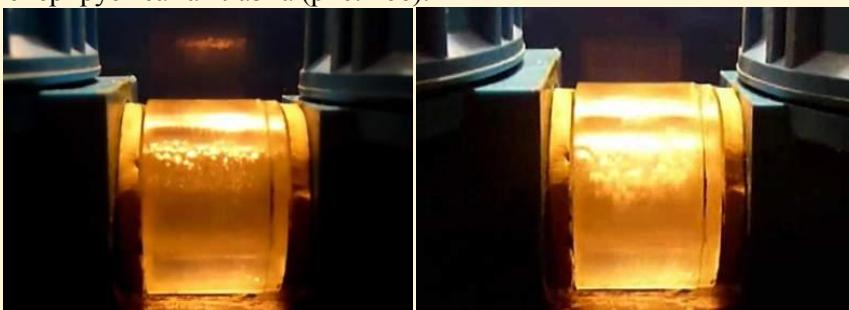
Рис. 166. Межэлектродная зона процесса нагрева и электролиза воды импульсами напряжения, формируемого плазмой у катода
