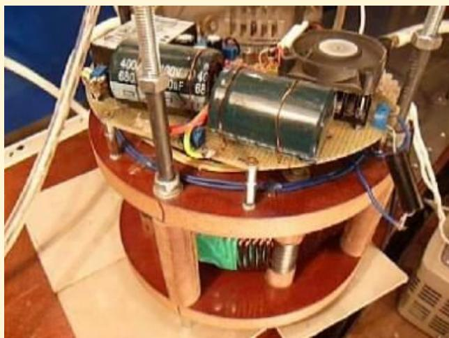
Рис. 160. Фото электромотора-генератора МГ-1
